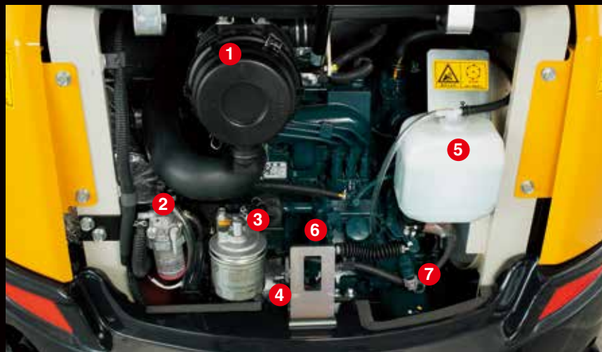
1. エアクリーナ 2. ウォータセパレータ 3. 燃料フィルタ 4. スタータモータ 5. リザーブタンク 6. エンジンオイルゲージ 7. エンジンオイルフィルタ
